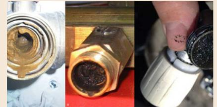
L'embouage diminue le rendement de l'installation en créant des zones froides dans les radiateurs, des vitesses de circulation diminuées dans les tuyauteries. Il réduit la durée de vie des installations en accélérant les phénomènes de corrosion, fatiguant les organes de circulation, obstruant les corps de chauffe.
