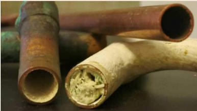
Le tartre, très bon isolant, provoque une perte d'échange thermique. Il favorise l'accumulation de dépôts et de boues qui entraînent le colmatage des tuyauteries, corrosions sous dépôt, développements bactériens, bruits et des points chauds fragilisant votre chaudière.
